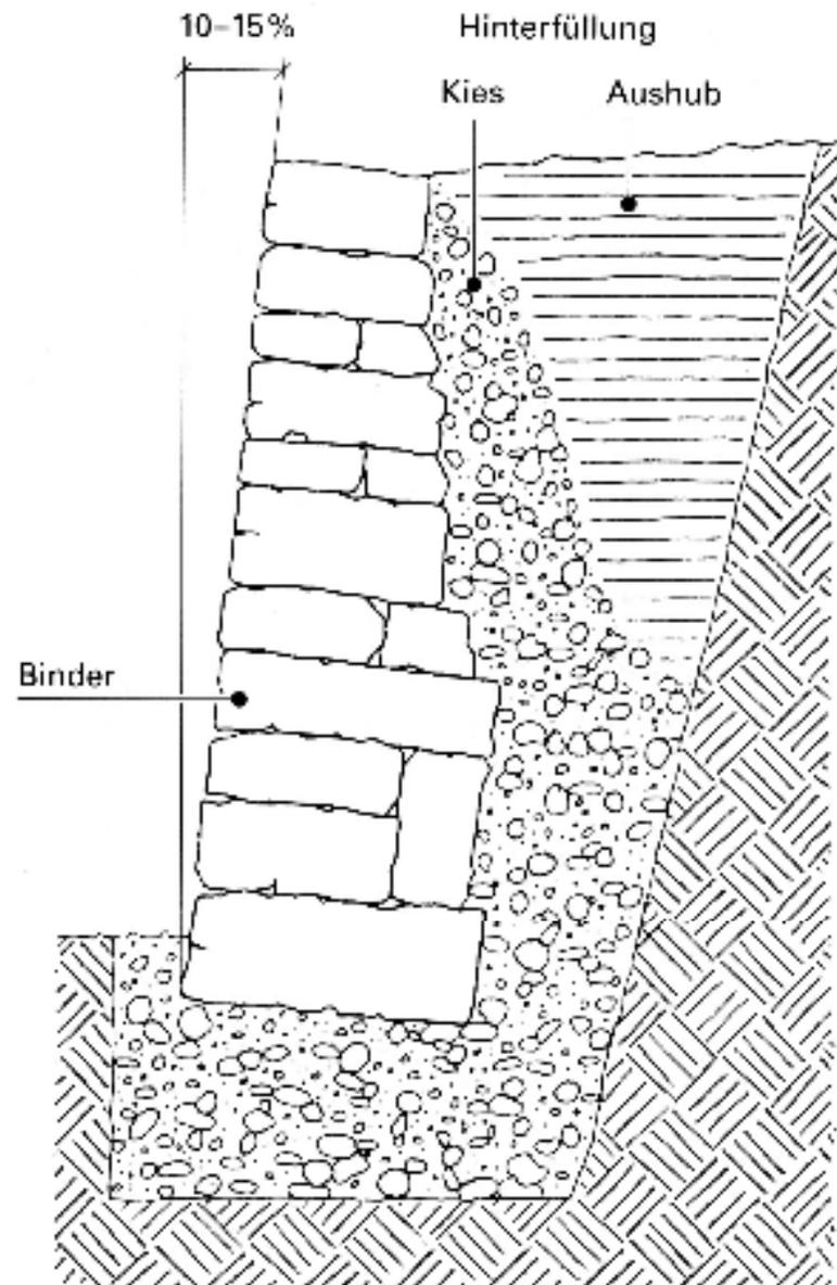
*Wichtig für die Stabilität von Trockenmauern: Frostsicheres Fundament und Hinterfüllung aus Kies oder Schotter; breiter Mauerfuss, Verjüngung (Anzug) nach oben; lange Steine, die durch die ganze Breite gehen (Binder) und auch längs verlegt werden (Läufer).*
